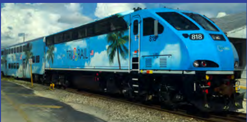
Locomotora de pasajeros BL36PH de 131.5 Ton/3600hp
